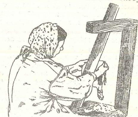
Рис. 5. Станок для обезжиривания шкурок.
