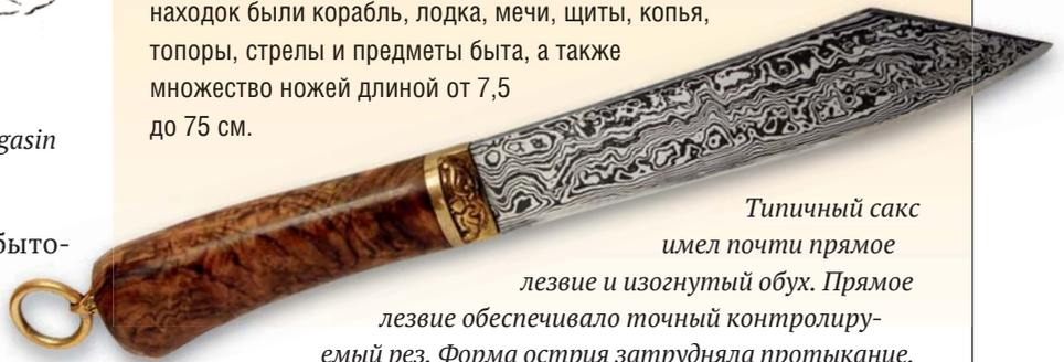
Типичный сакс имел почти прямое лезвие и изогнутый обух. Прямое лезвие обеспечивало точный контролируемый рез. Форма острия затрудняла протыкание, зато нож стал гораздо безопаснее
