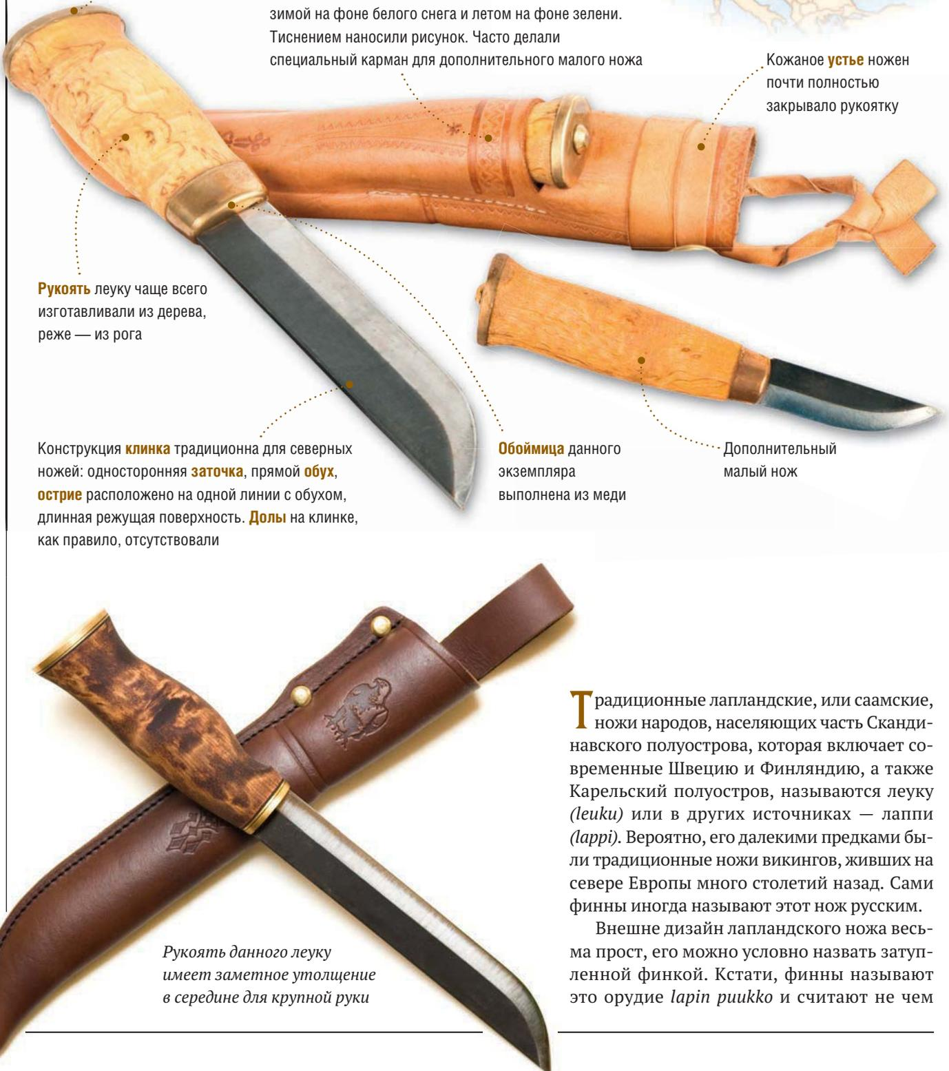
иным, как разновидностью финского ножа. Короткий широкий клинок имеет прямой обух. Крутой изгиб лезвия вверх к острию, которое расположено на одной линии с обухом, образует очень длинную режущую поверхность. Это отличный охотничий нож, для кинжального боя он пригоден плохо.
