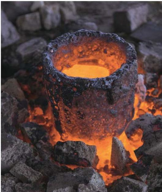
*Тигель с расплавленной железной рудой*
