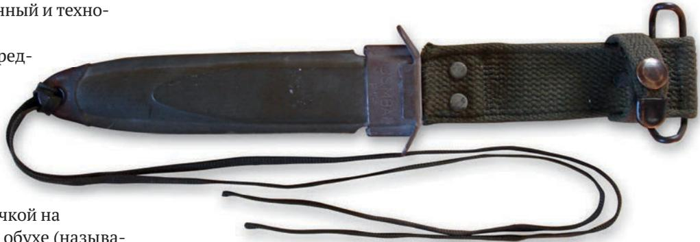
бил боксерскую грушу, баллистический жилет и лист авиационного алюминия. Рукоять с пятью кольцевыми и четырьмя вертикальными желобами, в стальном навершии находится двойная пружинная защелка. Ножны пластмассовые, с точилом для клинка, как и в M9.
