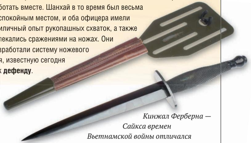
Кинжал Ферберна — Сайкса времен Вьетнамской войны отличался пластиковыми ножнами с пластинчатым металлическим подвесом характерной формы
