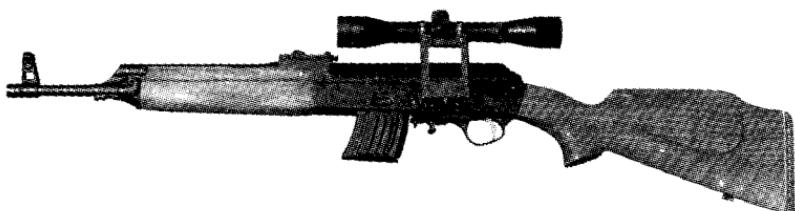
*Рис. 71. Самозарядный охотничий карабин ОЦ-25 на базе АКМ под патрон 7,62x39 мм.*
