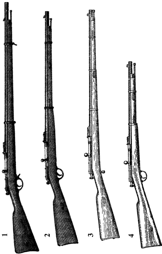
Рис. 3. Винтовки и карабин системы Бердан-2 образца 1870 г.: 1 – пехотная винтовка, 2 – драгунская винтовка, 3 – казачья винтовка, 4 – карабин.
