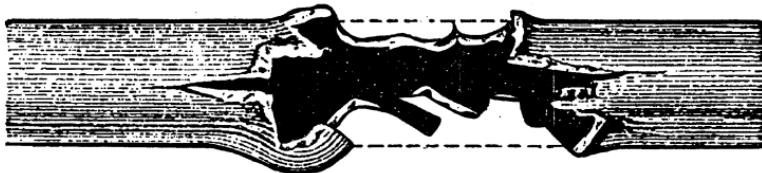
Рис. 9. Полный разрыв ствола с хорошо видимыми признаками растяжения металла.
