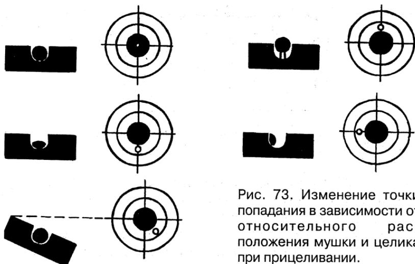
Рис. 73. Изменение точки попадания в зависимости от относительного расположения мушки и целика при прицеливании.
