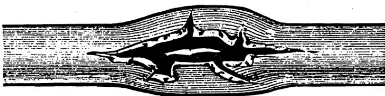
Рис. 8. Раздутость с трещинами и разрывом металла.
