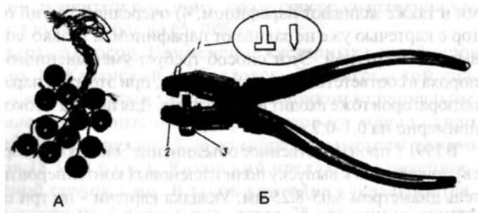
Рис. 53: А - связанный картечь; Б - плоскогубцы для нарезки картечи.
