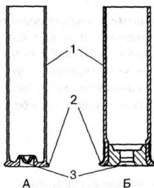
Рис. 1: Гильзы для гладкоствольного оружия: 1 - трубка гильзы, 2 - шляпка с бортиком, 3 - капсюльное гнездо. А - металлическая Б - папковая
