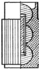
Рис. 55: Соединение трех картечин полиэтиленовой шпилькой
