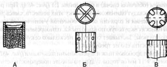
Рис. 48: Способы закрепления дробовых пыжей в металлических гильзах:
