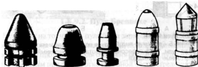
Рис. 25: Пули для оружия со стволами сверловки "парадокс".
