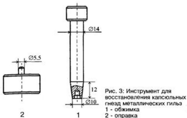
Рис. 3: Инструмент для восстановления капсюльных гнезд металлических гильз
