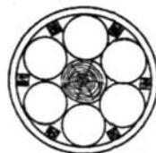
Рис. 50: Размещение картечи неполными рядами
