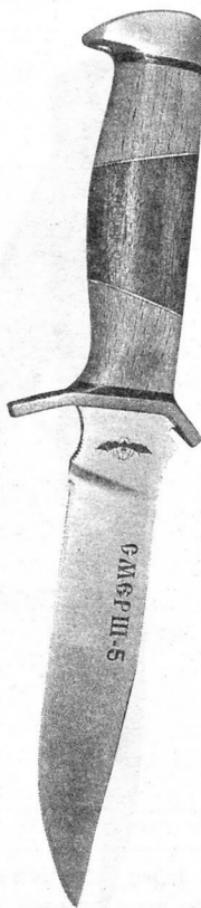
**Длина ножа 260 мм****Длина клинка 150 мм****Материал клинка сталь 95Х18 или ЭП853****Твердость клинка 56–58 HRC****Толщина клинка 4 мм****Форма клинка со скосом обуха****Рукоятка всадная****Ножны кожа с пластиковым вкладышем****Крепление ножен универсальное**
