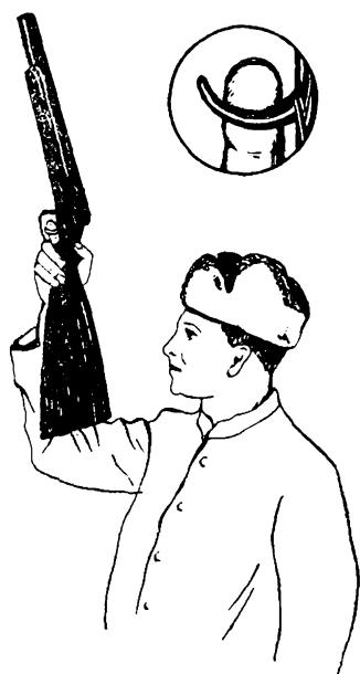
Рис. 15. Практический способ определения соответствия длины ложи длине руки стрелка
