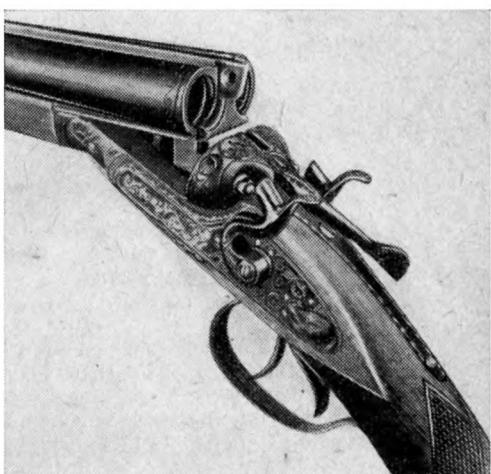
Рис. 1. Ружье ТОЗ-БМ со стороны ствольной коробки с раскрытыми стволами. Запирание тройное: верхнее — при помощи поперечного болта Гринера, нижнее — при помощи рамки Дж. Пэрдэя на оба пост вольных крюка
