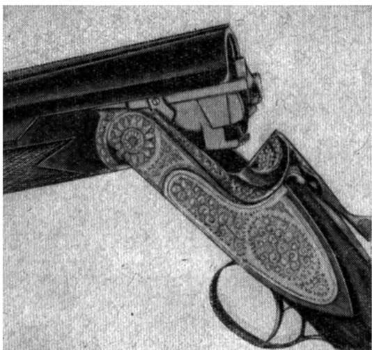
Рис. 16. Вид на ружье МЦ-109 со стороны ствольной коробки с открытыми стволами
