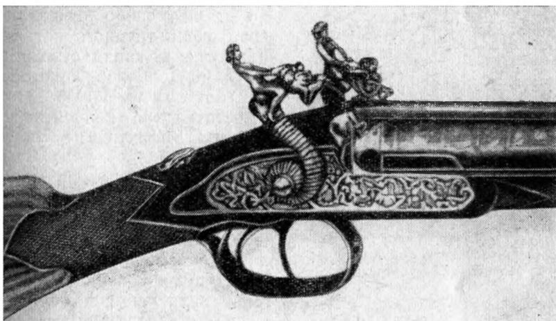
Рис. 5. Двуствольное ружье с ударно-капсюльными замками
