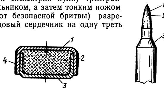
Рис. 51. Самодельный картонный пыж:
