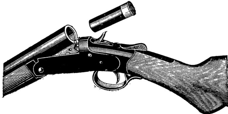
Рис. 53. Одноствольное ружье с откидным стволовом (ИЖ-5)
